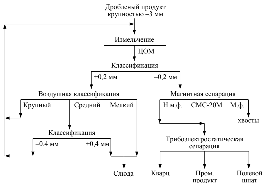
Рисунок 2. Схема испытаний полевого шпата по сухой технологии Figure 2. Dry technology tests circuit for feldspar
