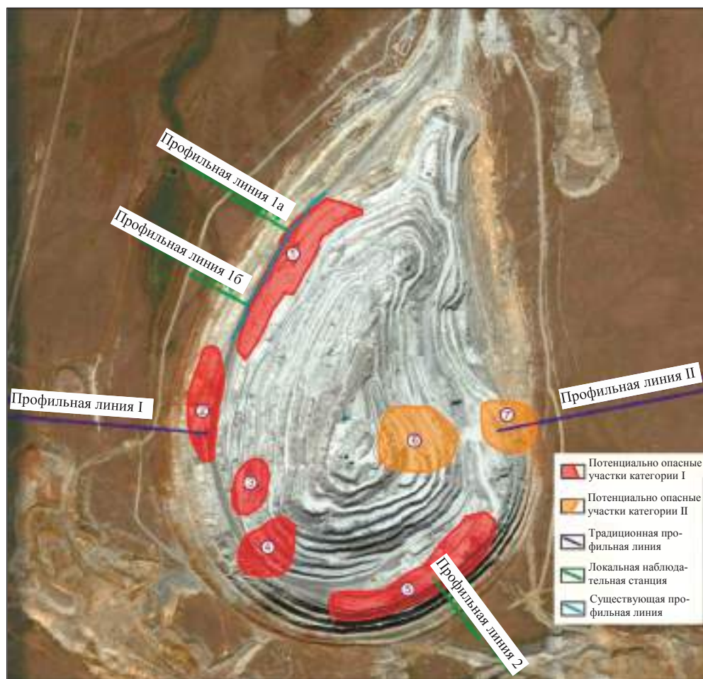
Рис. 5. Схема наблюдательной станции Кiemбаевского карьера
