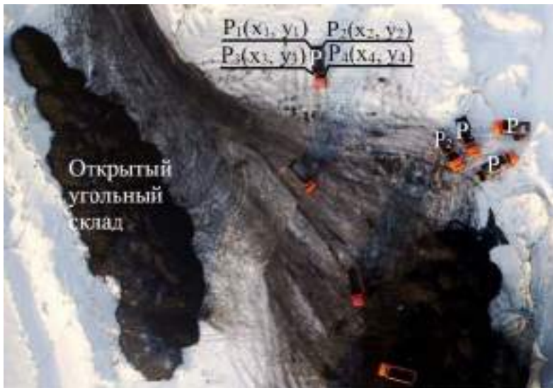
Рис. 2. Фрагмент цифровой модели рельефа с отображением открытого угольного склада и наземного технологического транспорта:
