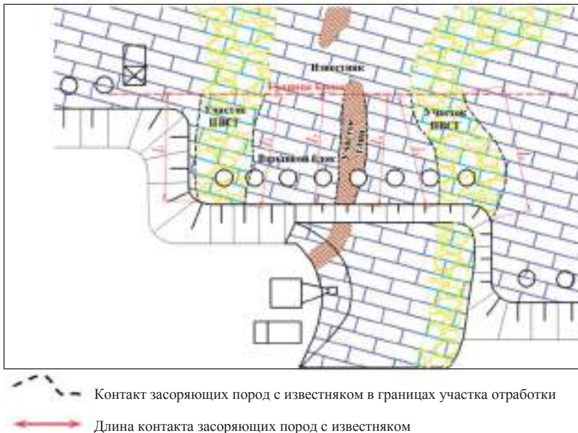
Рис. 4. Схема к определению длины контактов в границах обрабатываемого участка (взрывного блока)
