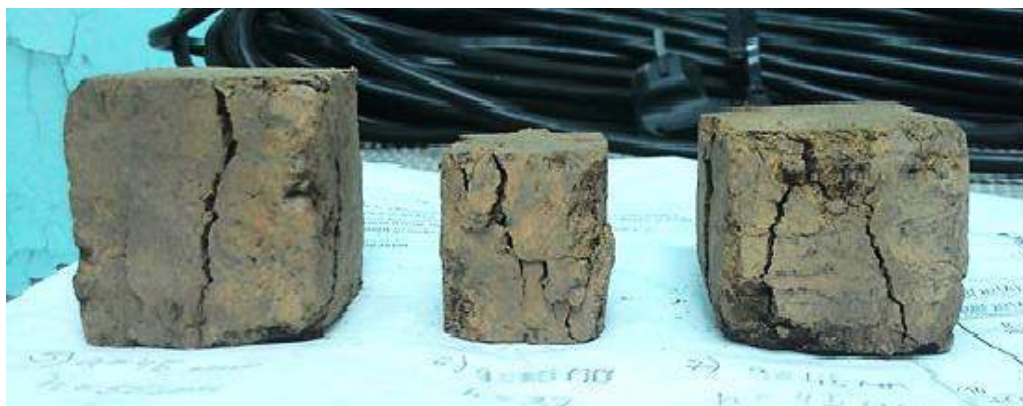
Рис. 1. Образцы суглинистых пород до и после испытания на одноосное сжатие: a – подготовленные образцы суглинистых пород перед испытанием; б – образцы суглинистых пород до и после испытания на одноосное сжатие
