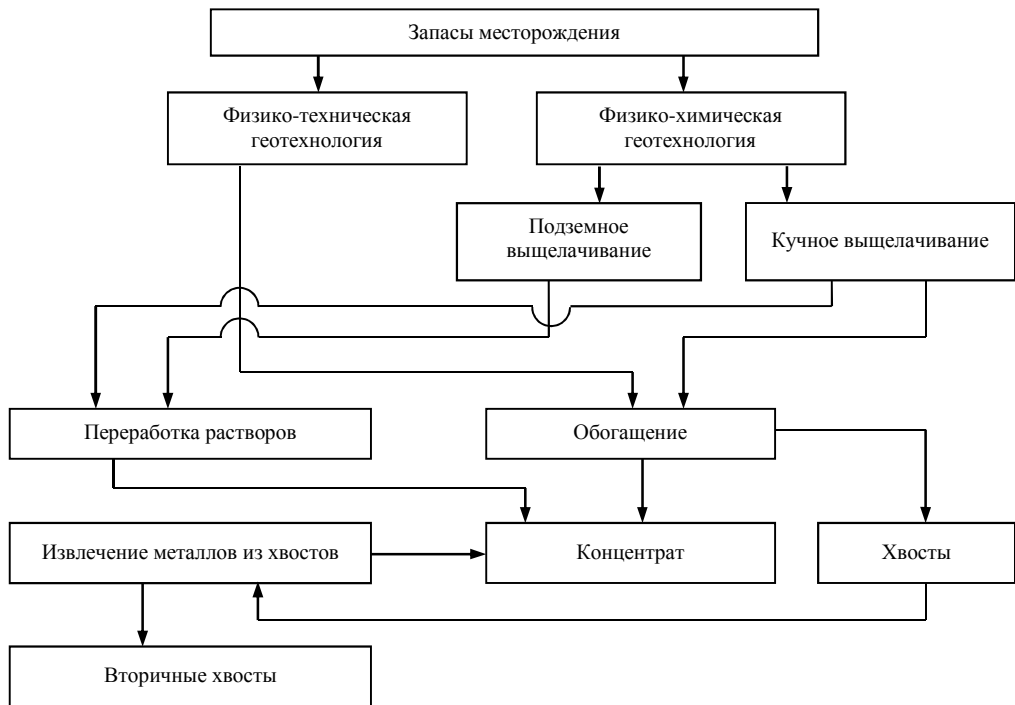
Рис. 2. Алгоритм комбинирования геотехнологий разработки месторождения
