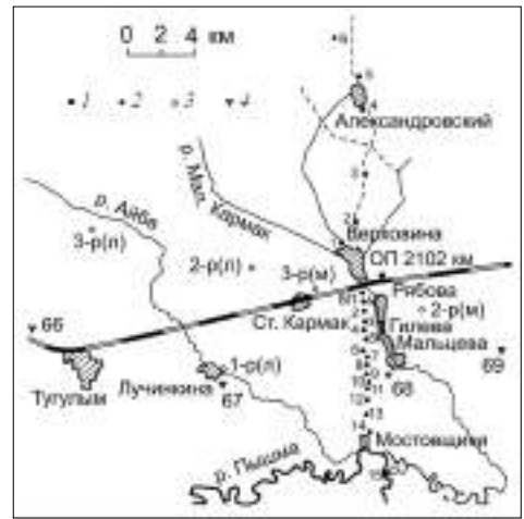
Рис. 1. Схема сети наблюдений: 1 – остановочный пункт 2102 км; 2 – точки измерения помех от ЭЖД; 3 – буровые скважины; 4 – пункты магнитотеллурического зондирования (МТЗ)
