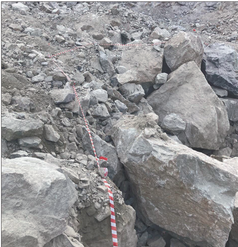
Рисунок 3. Разрушенный массив горных пород (рудный блок Ж-950-16): справа – целик (вскрышные породы), слева – взорванная руда Figure 3. Broken rock mass (ore block Ж-950-16): on the right – pillar (overburden), on the left – blasted ore
