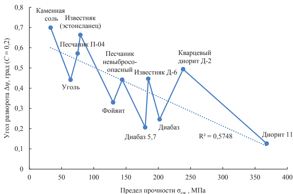
Рисунок 2. График зависимости угла разворота сдвиговых площадок в процессе упрочнения от предела прочности на одноосное сжатие
