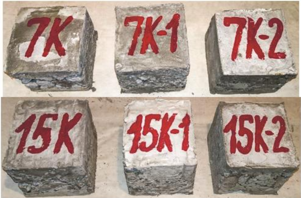
Рисунок 2. Отдельные образцы-кубы составов закладочной смеси на 7-е сутки твердения: a – партия № 1; б – партия № 2
