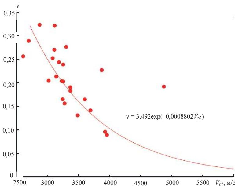
Рис. 3. Зависимость коэффициента Пуассона образцов, ориентированных перпендикулярно напластованию, от скорости продольной волны
