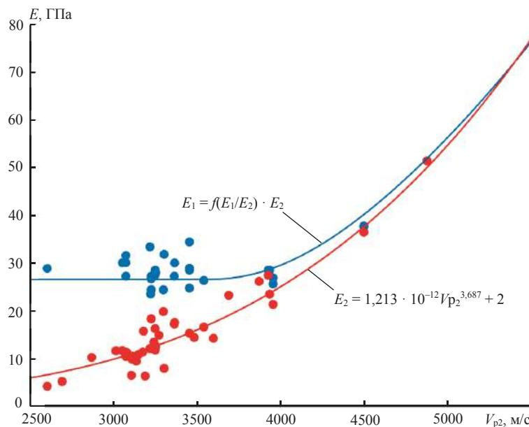
Рис. 2. Зависимость упругих параметров, полученных при недренированном нагружении, от скорости продольной волны
