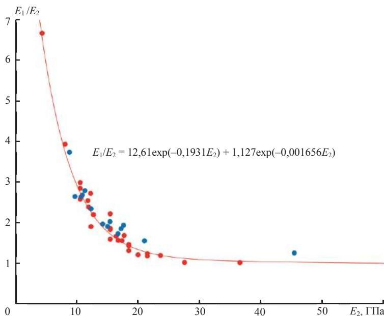
Рис. 1. Зависимость отношения модулей упругости  $E_1/E_2$  от модуля упругости  $E_2$
