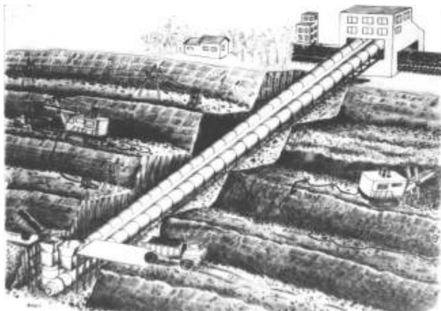
Рис. 2. Общий вид скиповой пневмоподъемной установки в карьере Fig. 2. General view of a skip pneumatic lifting installation in an open pit
