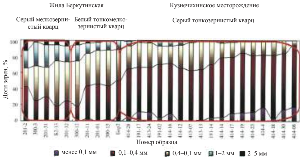
Рис. 1. Гистограмма распределения зерен по размерам в образцах гранулированного кварца [4]
